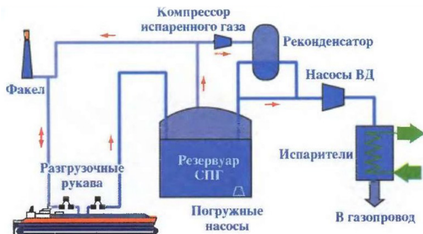
Рисунок 1. Принципиальная схема регазификационного терминала
