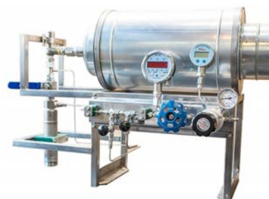
Рисунок 6. Стенд для настройки и пневмоиспытаний предохранительных клапанов
